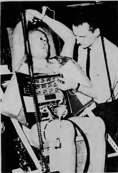
Aparaton medico ta ser hihá den e dummy transparente aki. Banda di cu shoulder tin instrumentonan qu ta transmii riza 12 canal radial pa relata loque ta sosodiendo cu e dummy durante e test.
